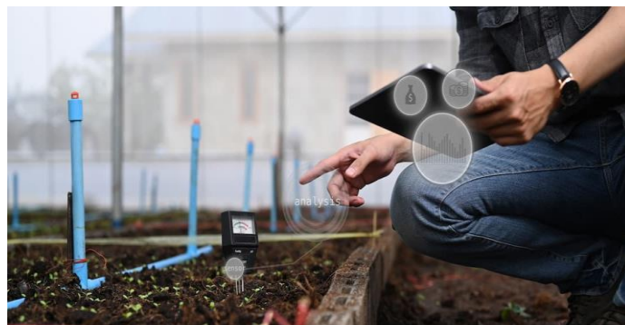
Photo 12: Les sondes hygrométriques pour mesurer le taux d'humidité du sol (synox.io).
